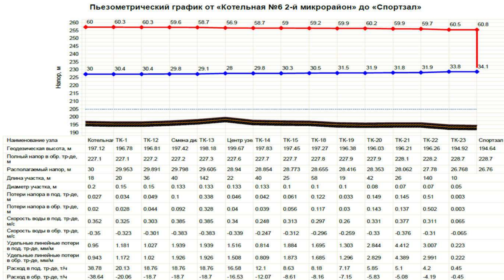
Рисунок 8 – Пьезометрический график котельная №6 – Спортзал
