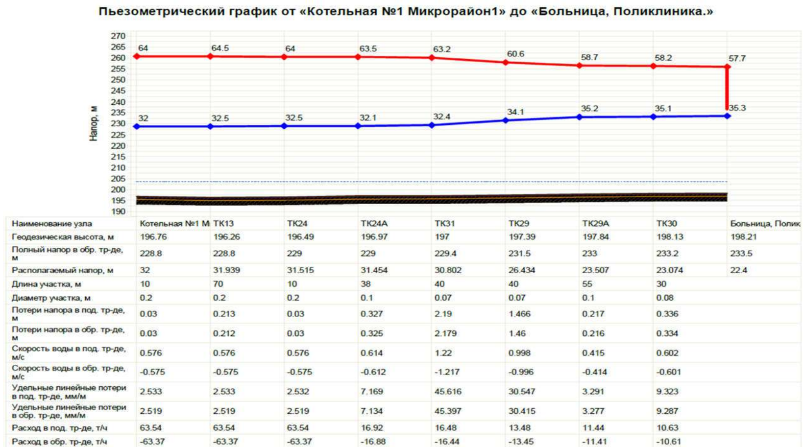
Рисунок 5 – Пьезометрический график котельная №1 – Больница, Поликлиника
